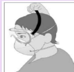
4. rimuovere il filtrante facciale afferrando gli elastici sul retro del capo ed eliminarlo nel contenitore per RSP-I se contaminato durante le manovre
